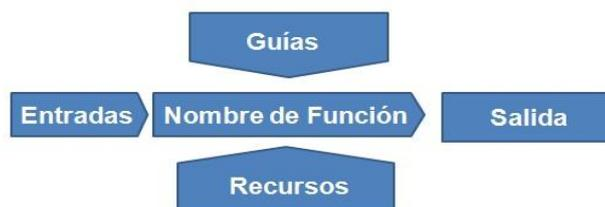
**Figura 1.2 Representación gráfica de un proceso en IDEF0.**
