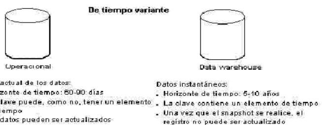
Figura 3: Contraste de la característica de variación de tiempo entre el ambiente operacional y el ambiente de depósito de datos.
