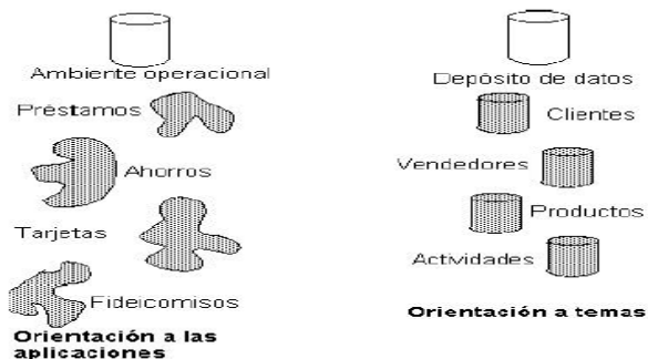
Figura 1: Contraste entre la orientación a las aplicaciones y la orientación a temas
