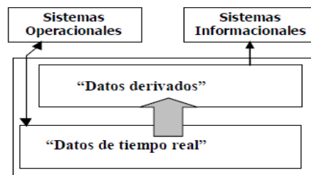
Figura 9: Arquitectura de datos de dos capas.
