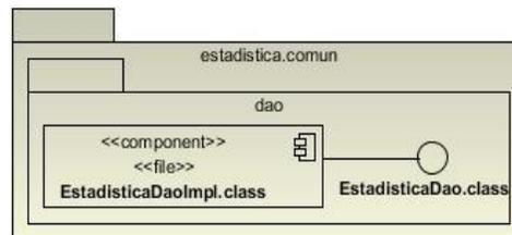
Figura 27: Diagrama de Componentes del Subsistema Común (Vista de Acceso a Datos).
