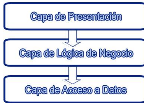
Figura 4. Arquitectura en tres capas.
