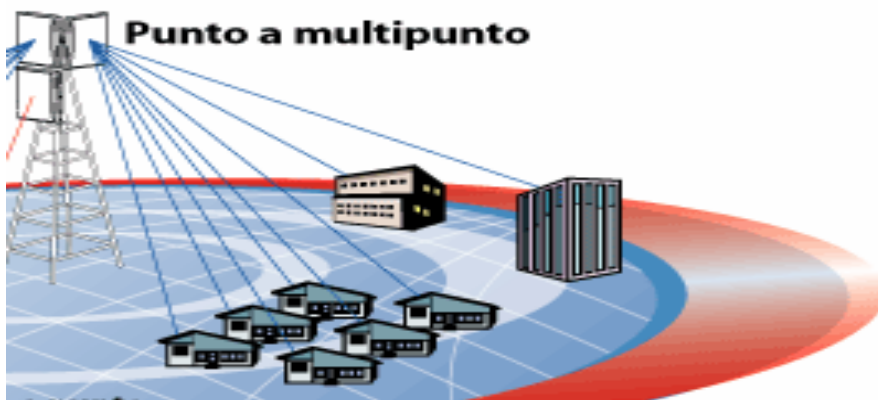
Figura 7: Estructura de una red punto a multipunto.
