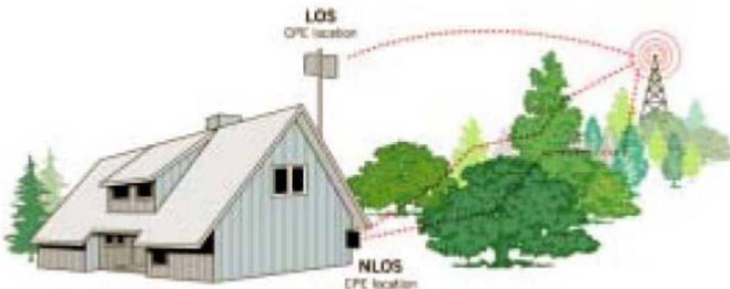
Figura 19: Ubicación del equipo de abonado (CPE) para condición NLOS.
