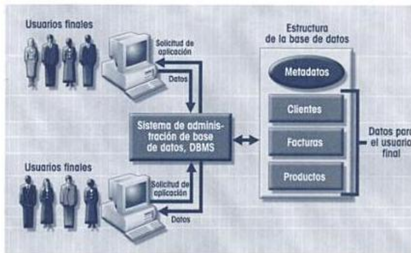
Fig. 1 Interacción del SGBD con el usuario final y la BD. (Peter Rob, 2003)
