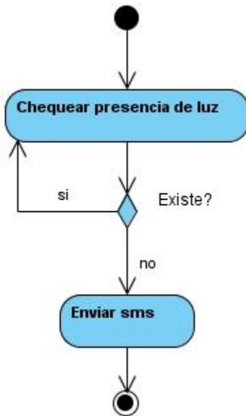
El módulo chequea la presencia de intrusos donde se encuentre instalado, el recibe un haz de luz infrarroja, cuya presencia es chequeada constantemente, si no se detecta la presencia del haz de luz, se envía un SMS alertando de la presencia de un intruso.
