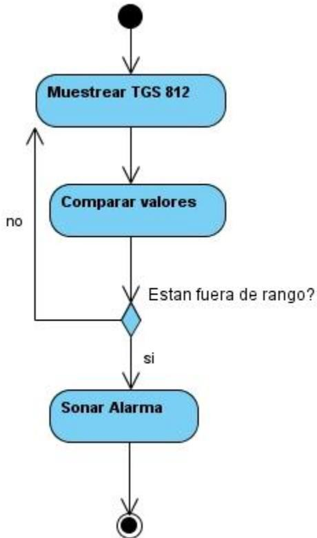
El módulo realiza un muestreo sobre el sensor TGS 812 que es un sensor de gas analógico el cual da una salida de voltaje en un rango determinado en caso de presencia de gas. Las muestras obtenidas se comparan con voltajes de referencia, dicha comparación determina si está en el rango de presencia de gas, en caso de que haya gas suena una alarma.
