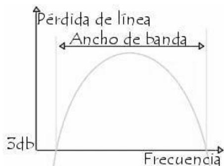
Ilustración 5-Ancho de banda y capacidad del canal.
