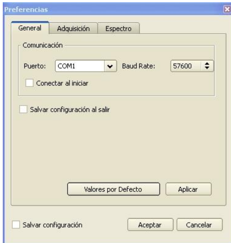
Figura 31: Interfaz del software para establecer la comunicación con el dispositivo MC-mcSystem.
