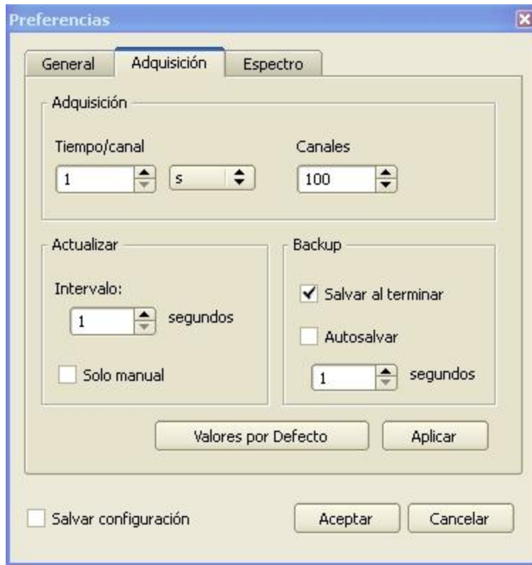
Figura 32: Interfaz del software para la configuración de la adquisición desde el dispositivo MC-mcSystem.
