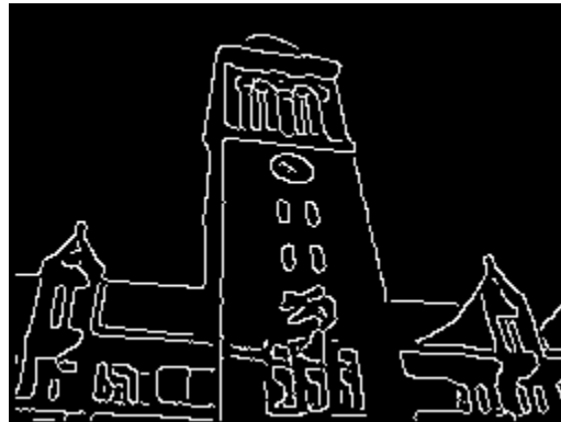
Figura 11. Resultado de aplicar el Algoritmo de Canny.
