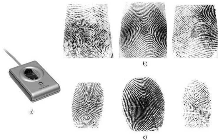
Figura 8. Lector óptico usado y ejemplo de imágenes obtenidas con el propio lector.
