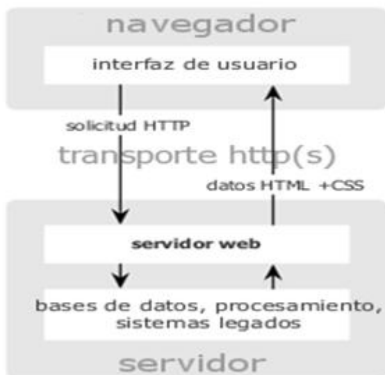
Figura 5: Modelo Clásico de aplicaciones web
