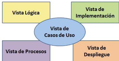
Figura 7-- Vistas arquitectónicas de RUP
