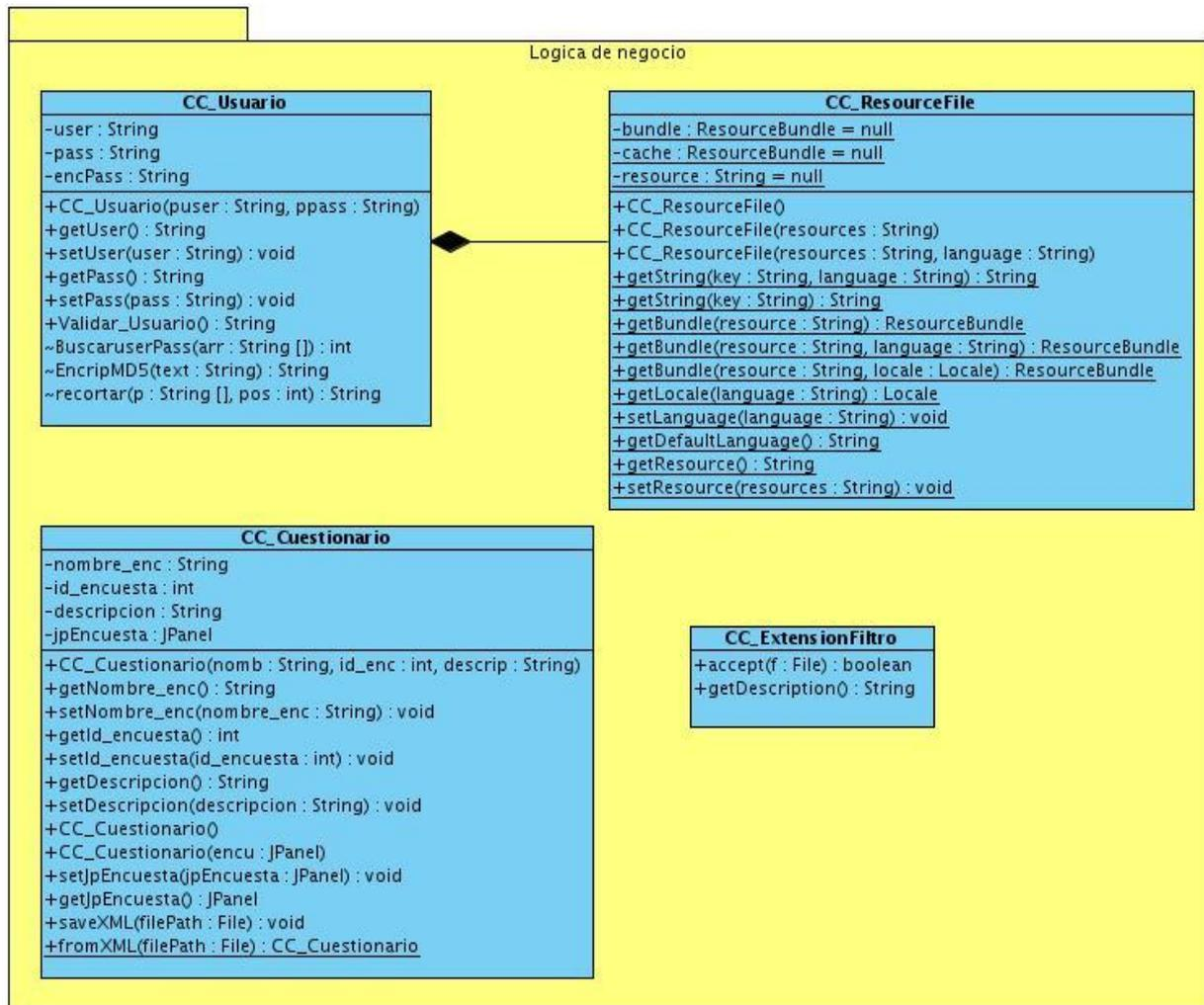
Figura 17. Diagrama de clases del Diseño Capa Lógica de negocio
