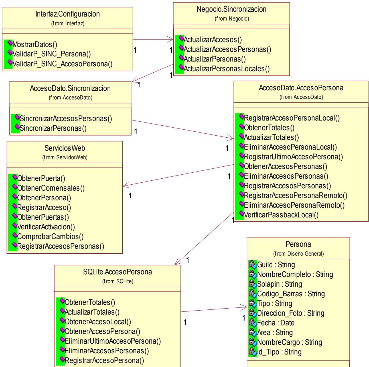
Figura 22. Diagrama de Clases de Diseño del Caso de Uso “Sincronizar_Acceso_Persona”.
