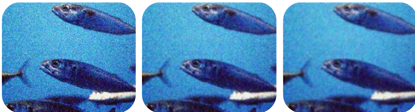
Fig. 25: a) Imagen original con ruido gaussiano b) Binomial con máscara 3x3 c) Binomial con máscara 5x5
