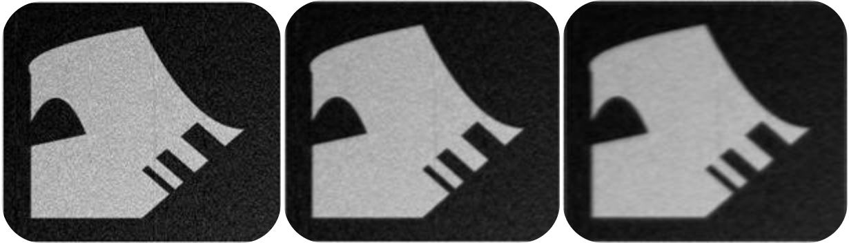
Fig. 10: a) Imagen con ruido gaussiano b) Imagen resultante del algoritmo de la media con una máscara de 3x3 c) Imagen resultante del algoritmo de la media con una máscara de 5x5
