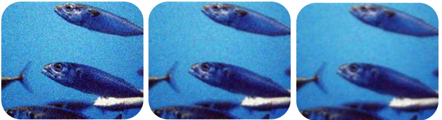
Fig. 22: a) Original con ruido gaussiano b) Media con máscara 3x3 c) Media con máscara 5x5
