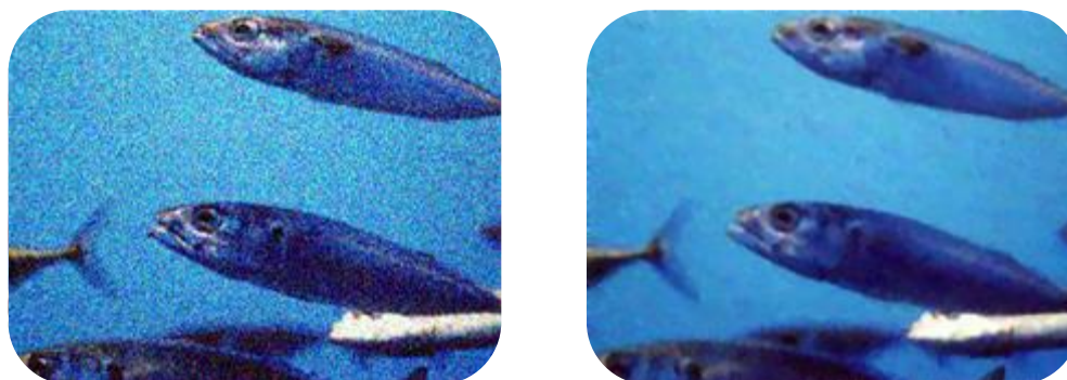
Fig. 24: a) Imagen original b) Con algoritmo de la Mediana Ponderada del Entorno de Vecindad con tamaño 3x3
