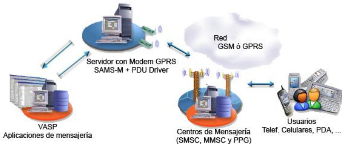
Figura 12 Entorno aplicación de SAMS-M con un driver para el protocolo PDU
