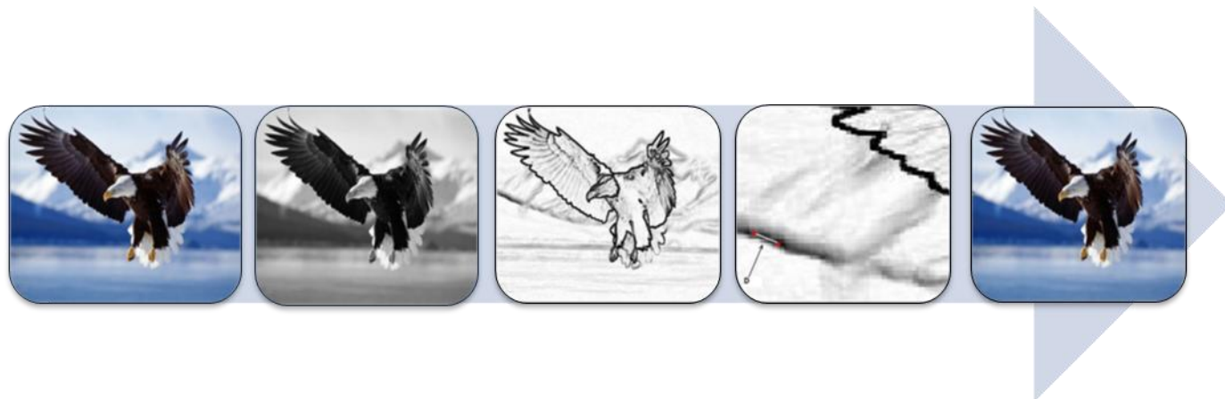
Figura 11: a) Imagen original, b) Imagen en escala de grises, c) Imagen con detección de contornos, d) Imagen con segmentación e inserción de la marca e) Imagen resultante
