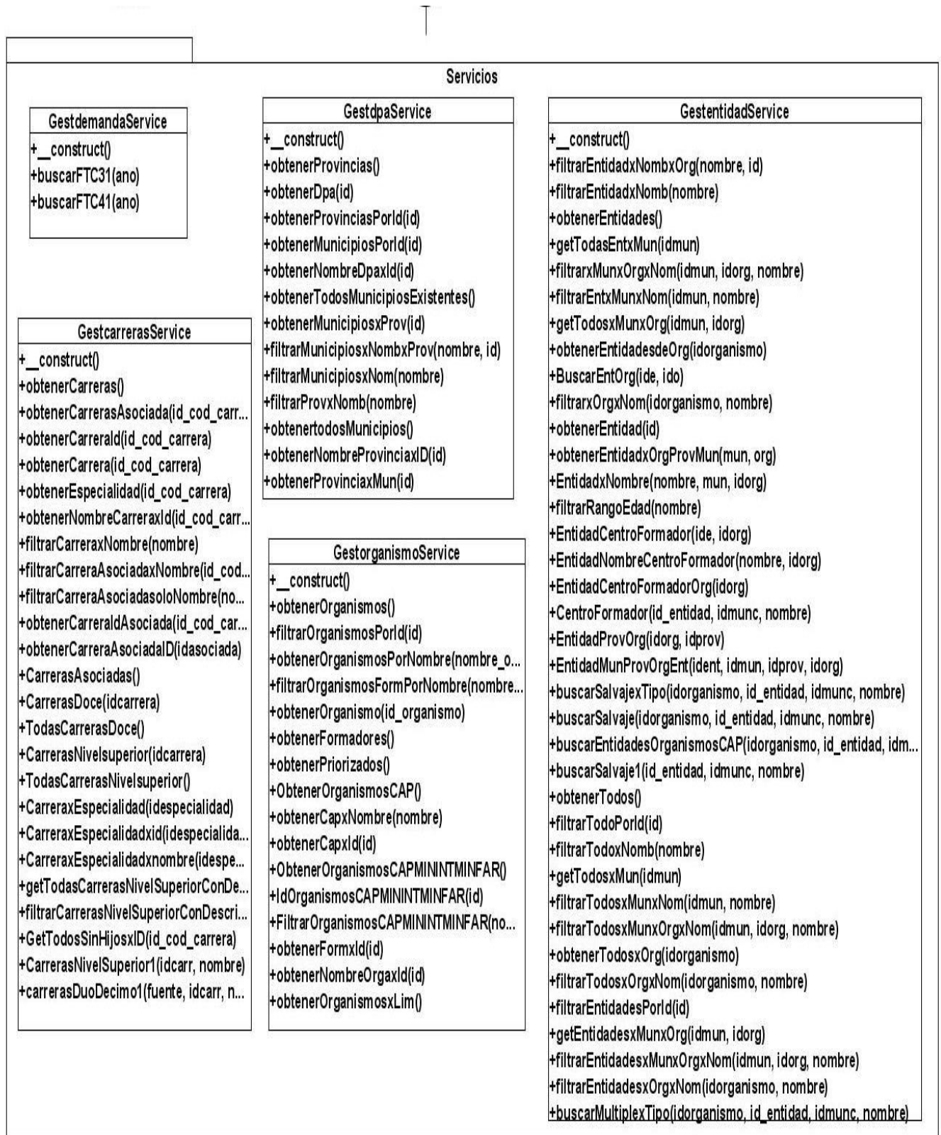
Figura #6 Diagrama de clases del diseño CUS “Gestionar demanda”, paquete “Servicios”.
