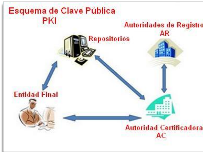
Figura 1. Esquema de los componentes de la PKI
