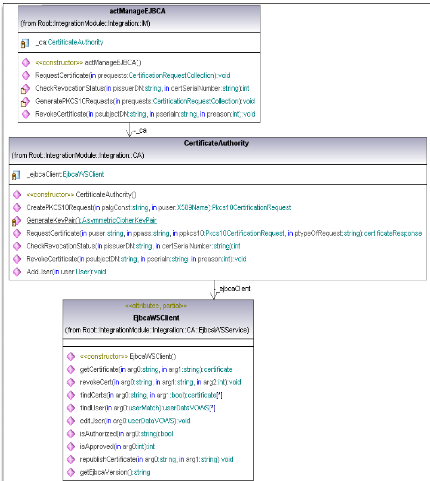
Figura 5: Diagrama de Clases de la acción Manejar Autoridad Certificadora
