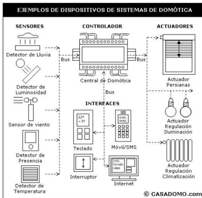
Figura 1: Ejemplos de dispositivos de un sistema domótico
