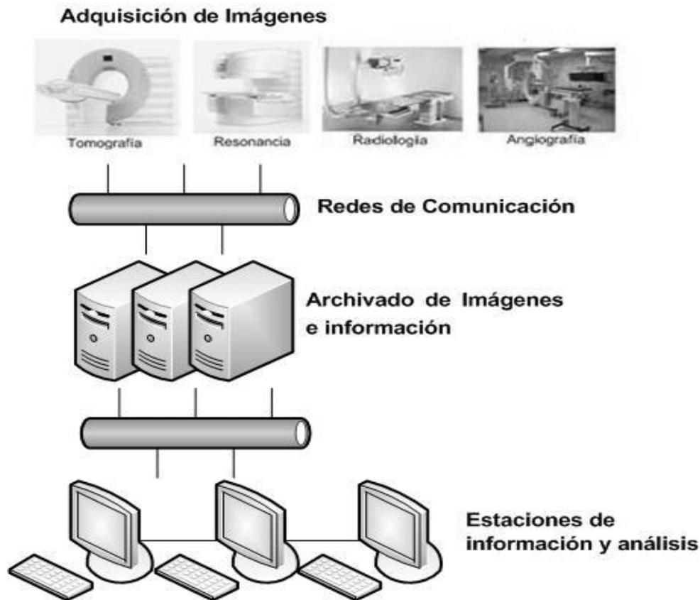
Fig. 1.1 Componentes de un PACS.
