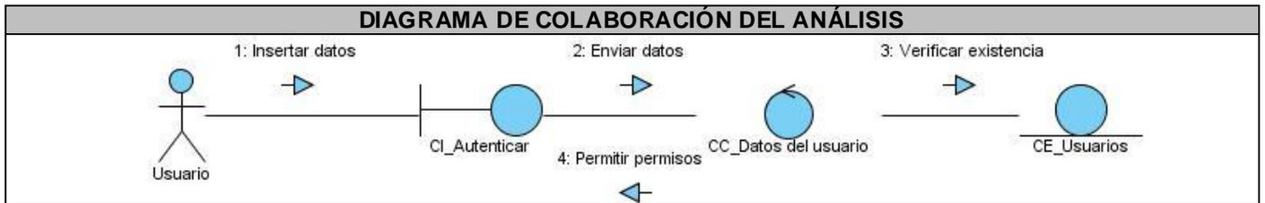
Figura 3.6-. Diagrama de colaboración del análisis: Caso de Uso Autenticar usuario.
