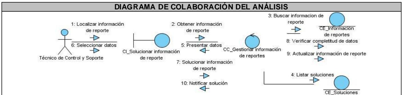
Figura 3.11. Diagrama de colaboración del análisis: Solucionar información de reportes.
