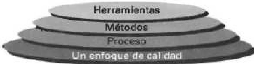
Fig.3 Capas de Ingeniería de Software. [Pressman, 2000]
