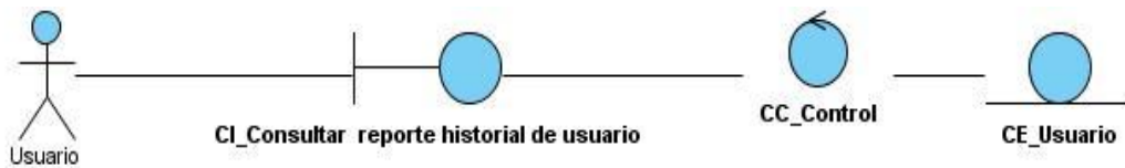
Figura 25: Diagrama de Clases del Análisis del Caso de Uso Consultar Reporte Historial de Usuario
