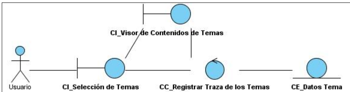
Figura 3.1 Diagrama de clases del análisis del caso de uso “Registrar traza del módulo Temas”
