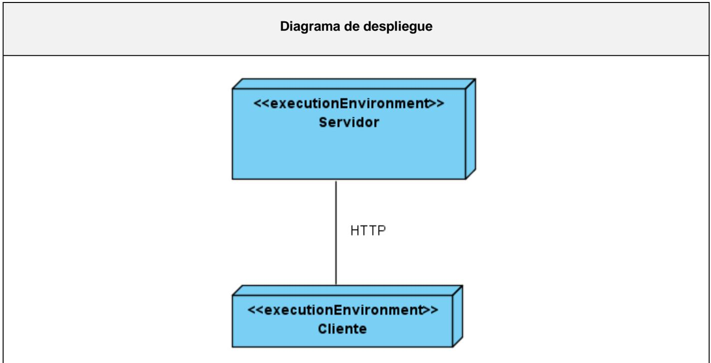
En el nodo *Servidor* se instala el servidor web Apache y el gestor de bases de datos PostgreSQL. El nodo *Cliente* permite a los usuarios interactuar con la aplicación y debe tener instalado alguno de los navegadores propuestos en los requisitos no funcionales de software.
