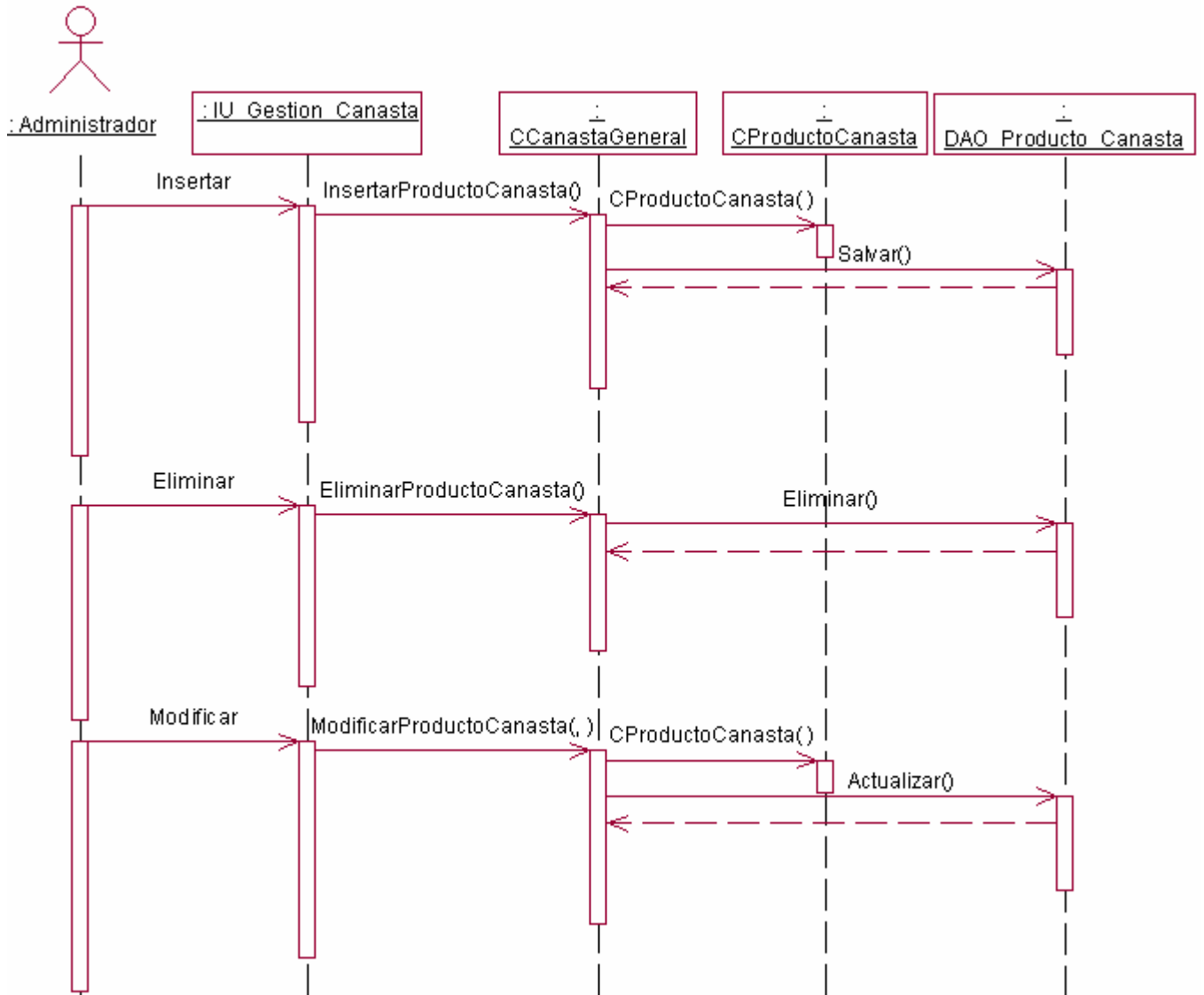
Figura 20. Diagrama de secuencia CU Gestionar Canasta.
