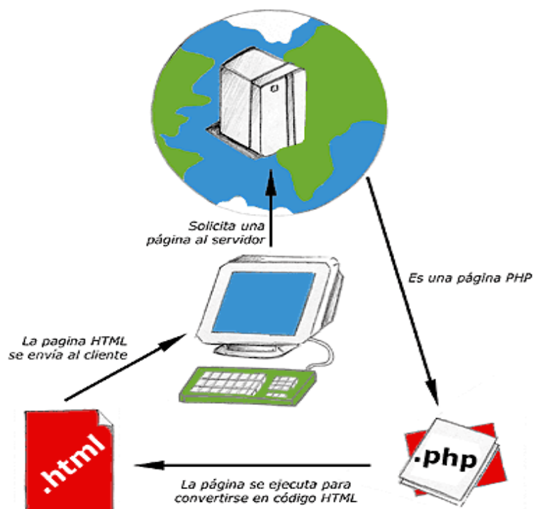
Figura 1.1. Esquema del funcionamiento de las páginas PHP. (Albert 2005)
