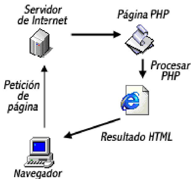
Figura 1.2. Esquema de representación del PHP.
