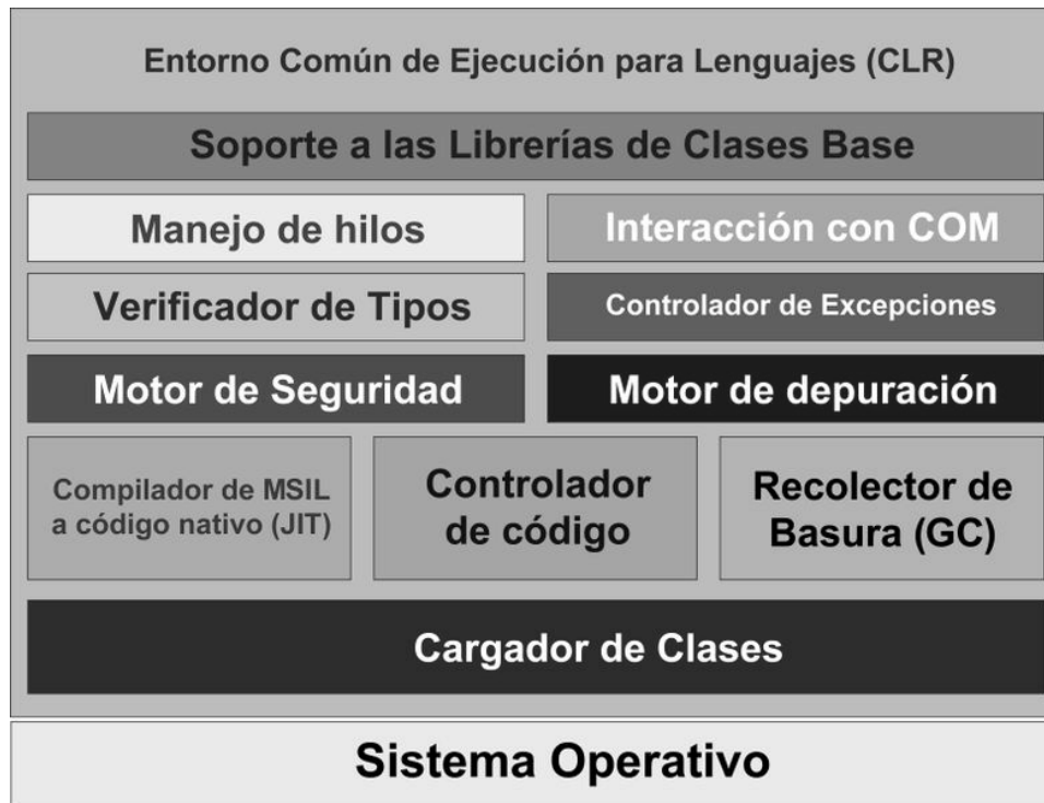
Figura 5. Diagrama de la estructura interna del Entorno Común de Ejecución para Lenguajes.
