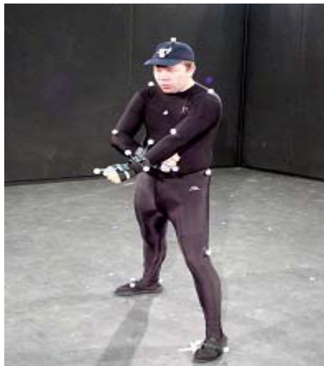
Figura 2: Sistema pasivo de captura de movimiento óptica.
