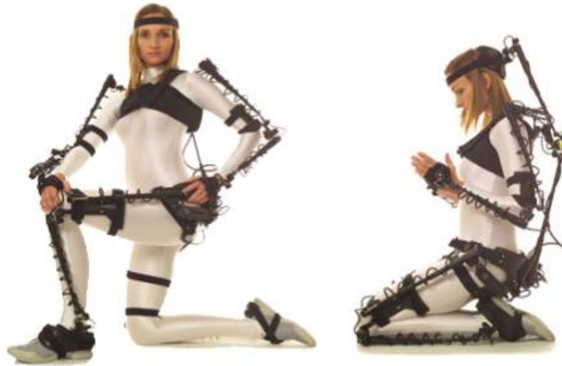
Figura 5: Gipsy 4. Sistema mecánico de captura de movimiento.
