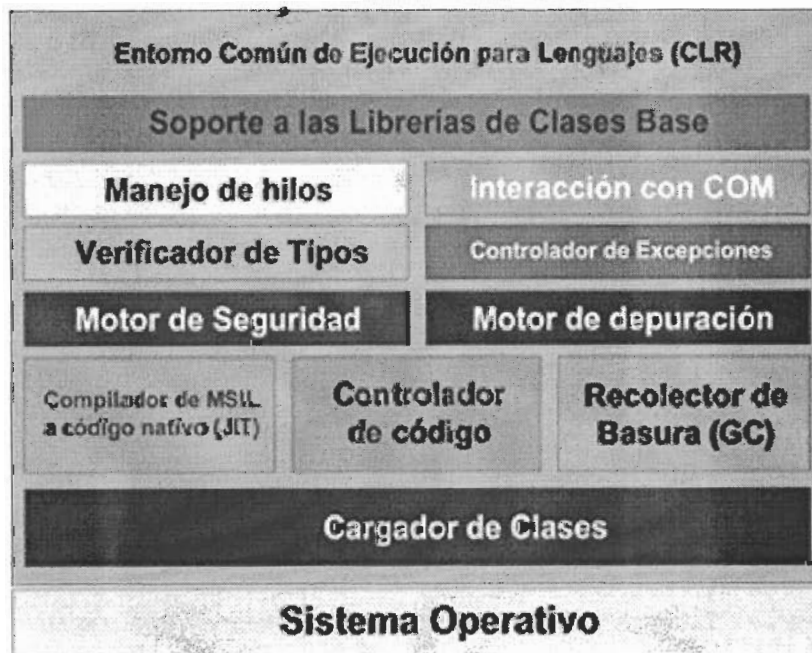
Figura1.5 Entorno Común de Ejecución para lenguajes (CLR)
