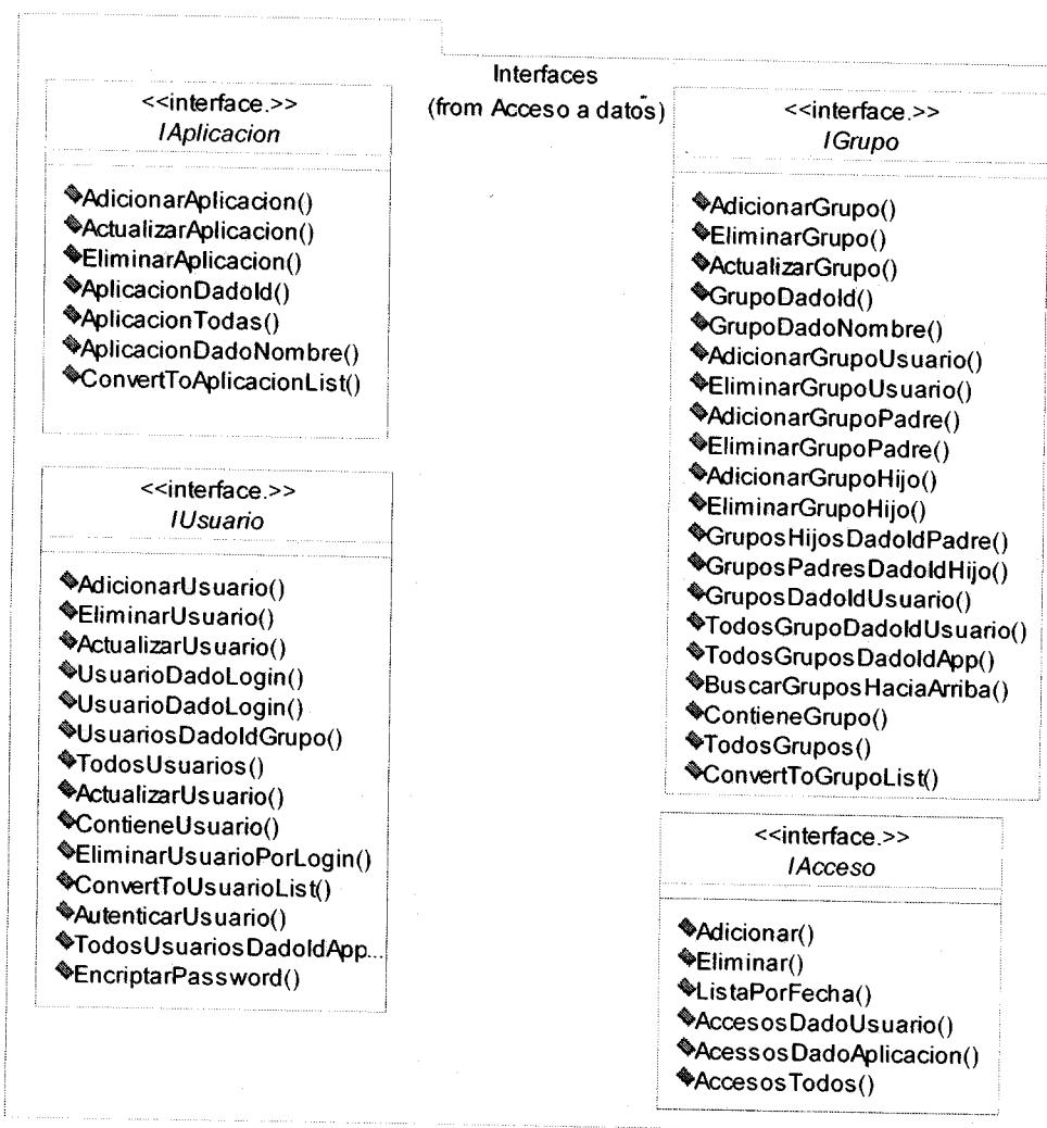
Figura 4. Diagrama de clases del paquete Acceso a datos (Subpaquete Interfaces)
