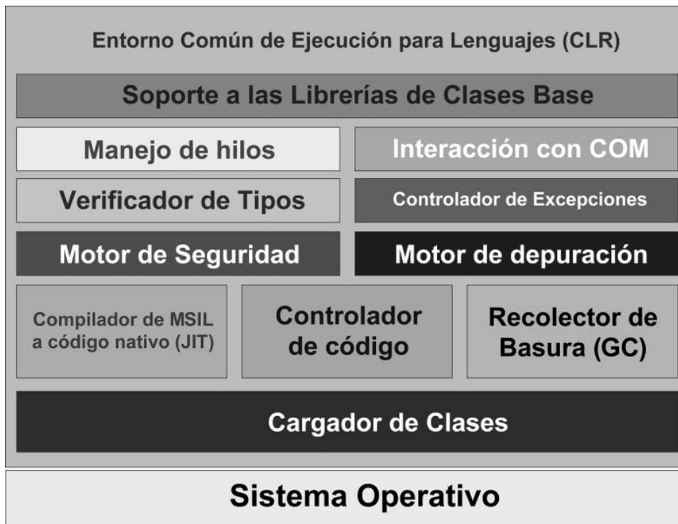
Figura 4. Diagrama de la estructura interna del Entorno de Común de Ejecución para Lenguajes (CLR por sus siglas en inglés).
