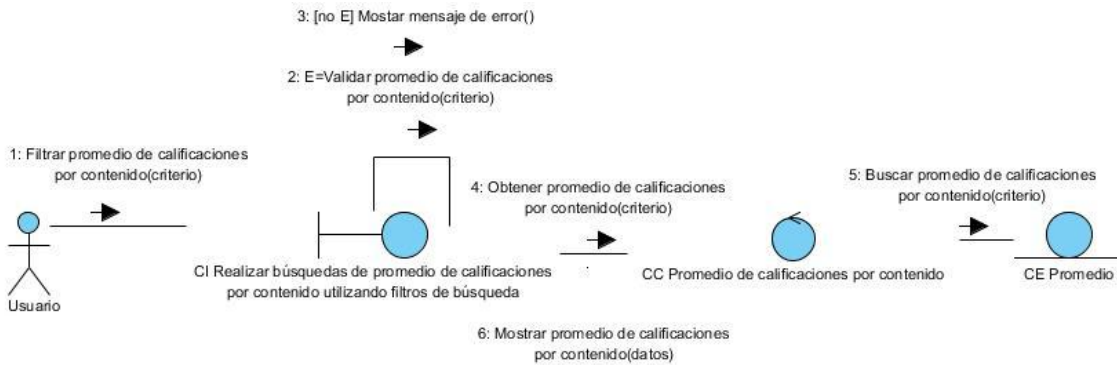
Figura 38. Diagrama de colaboración del análisis del CU Consultar promedio de calificaciones por contenido por estudiantes. Realizar búsquedas de promedio de calificaciones por contenido, utilizando filtros de búsqueda.
