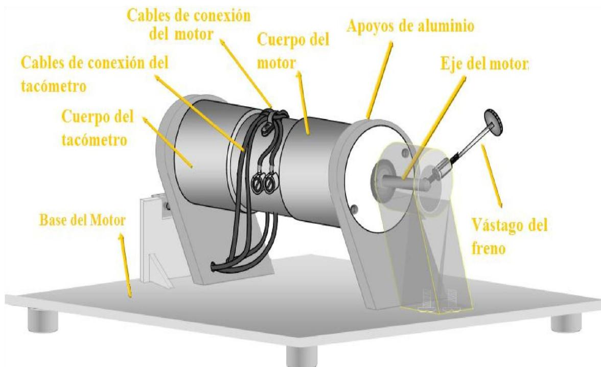
Partes de la maqueta del motor.
