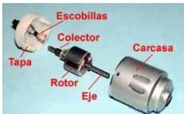
Figura 2. Partes principales de un motor de CC.
