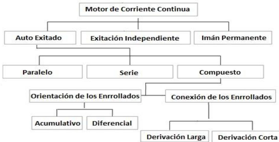
Figura 5. Clasificación de los motores de Corriente Continua (CC).
