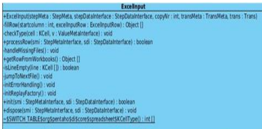
Fig. 10 Fragmento del diagrama de clases donde se evidencia el uso de los patrones GRASP: Controlador.
