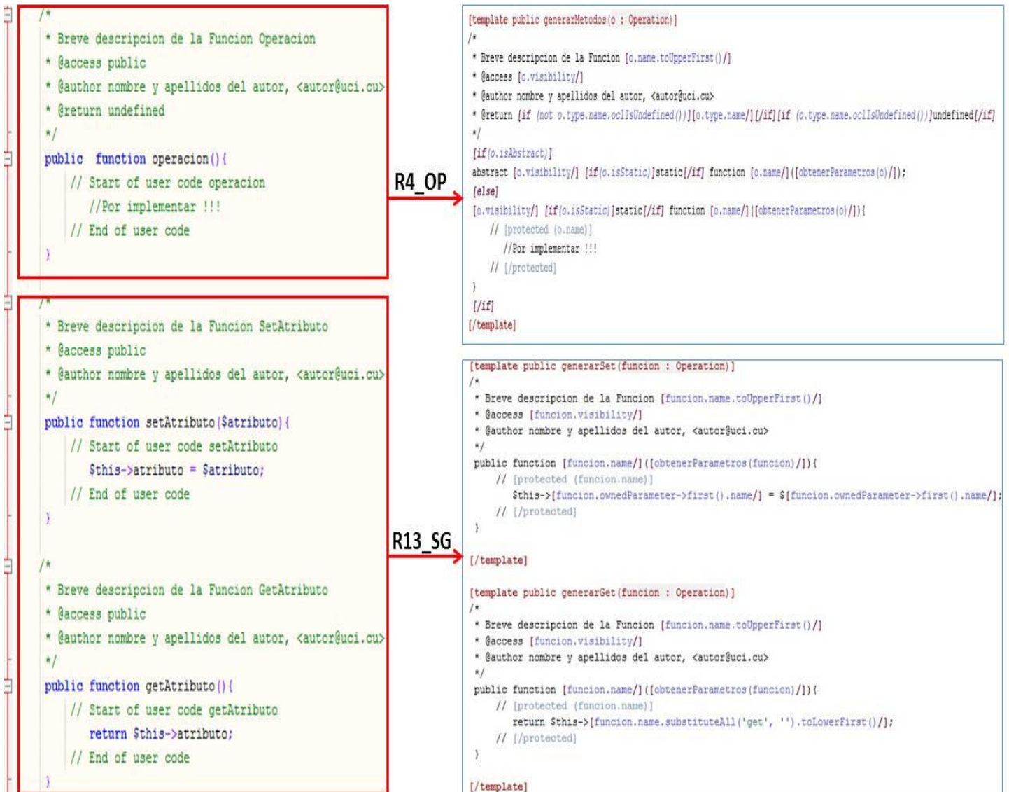
Figura 13: Aplicación de las reglas de transformación para la obtención del código fuente
