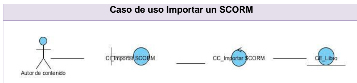
Figura 12. Diagrama de clase del análisis del caso de uso Importar un SCORM
