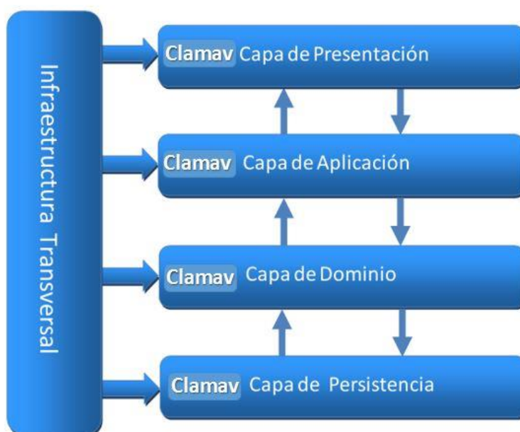
Figura 3: Arquitectura del módulo
