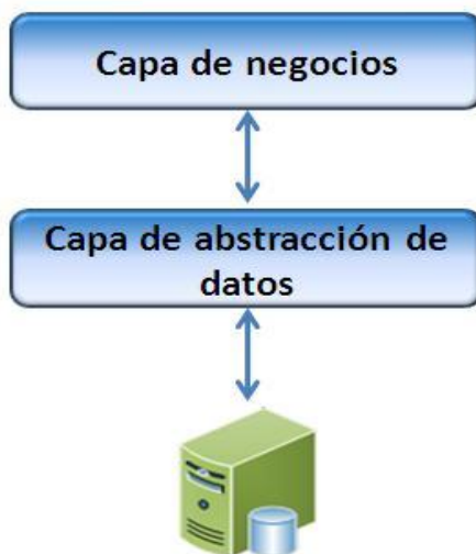
Figura 8. Patrón arquitectónico 2-Capas.
