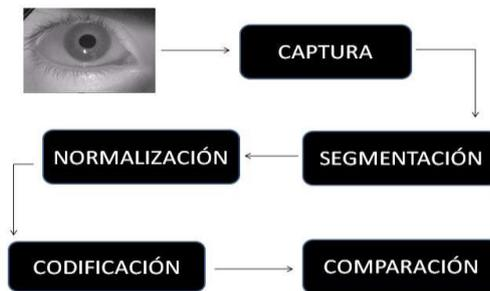
Figura 2: Diagrama en bloque del sistema de reconocimiento del iris.
