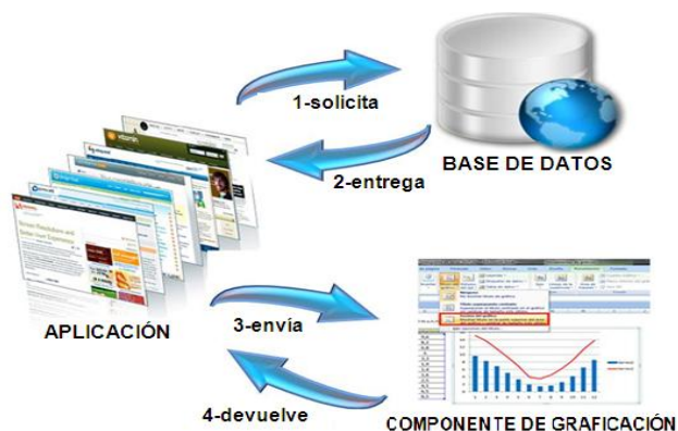
Figura 2: Proceso de graficación con el empleo de una solución externa
