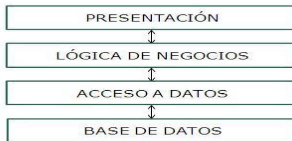
Figura 4: Representación arquitectónica del sistema SACOI-AA en capas usando MVC.
