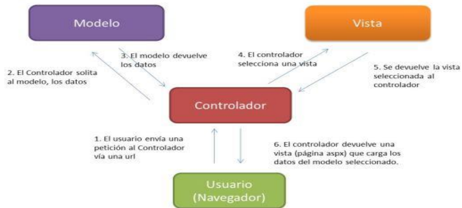
Fig. 6: Estructura de intercambio de información en el patrón MVC.
