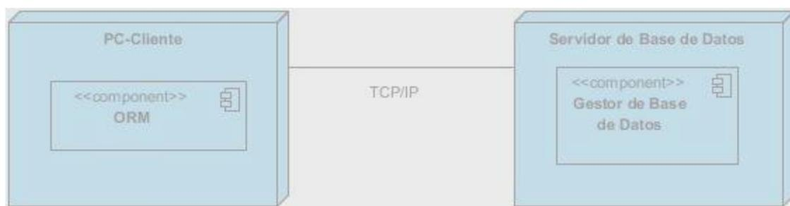
Figura 15: Diagrama de Despliegue
