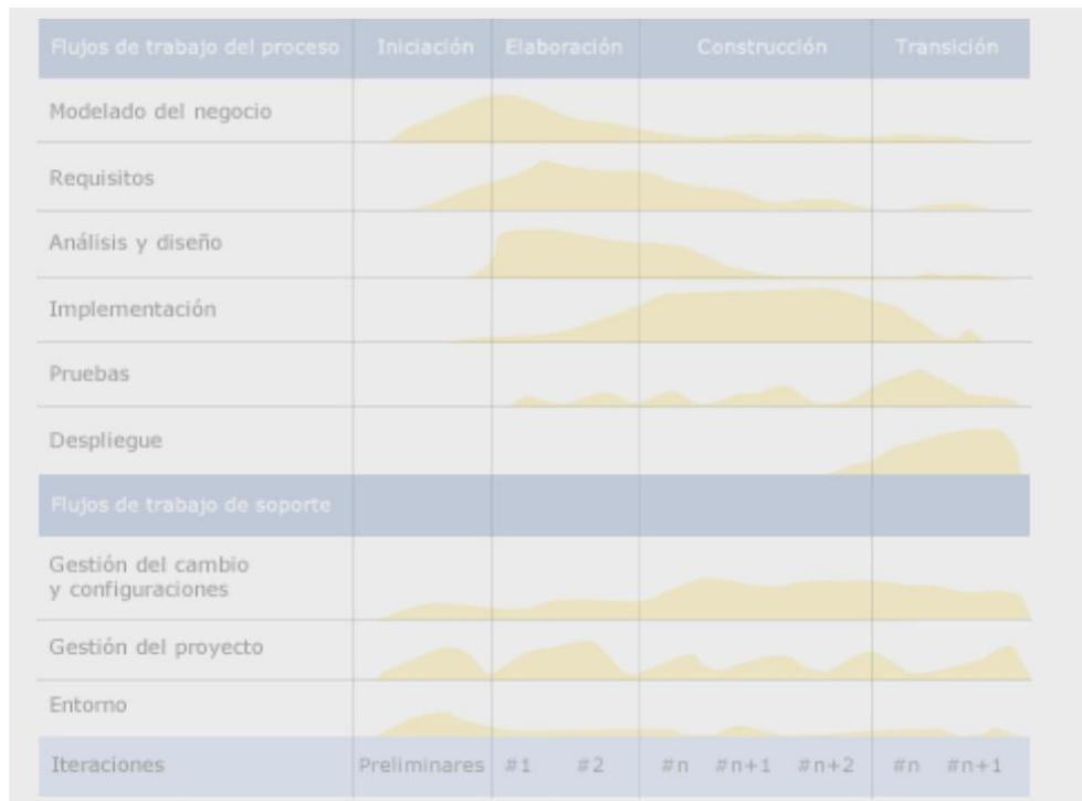
**Figura 6: Diagrama del esfuerzo de actividades según las etapas del proyecto.**
