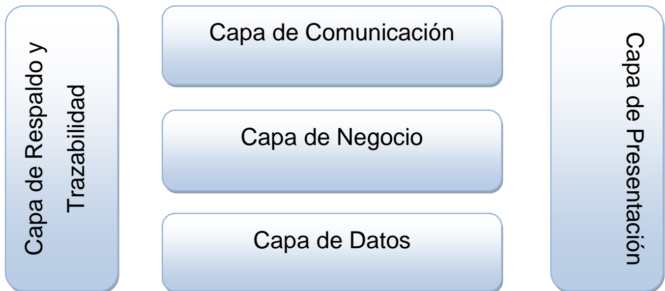
Fig. 5 Arquitectura en capas
