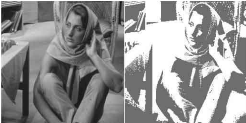
Figura 46. Izquierda: Imagen Bárbara original. Derecha: Resultado de aplicar el filtro Umbral Binario.
