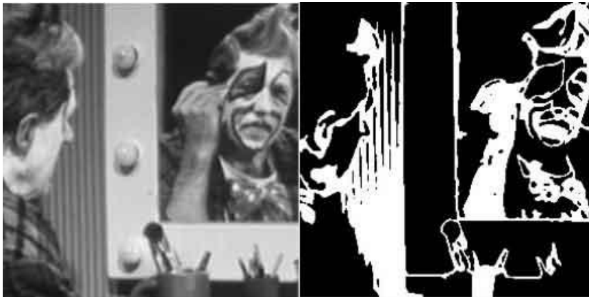
Figura 51. Izquierda: Imagen Clown al aplicar el filtro Promedio. Derecha: Resultado al aplicar la técnica de segmentación Conectar Umbral.
