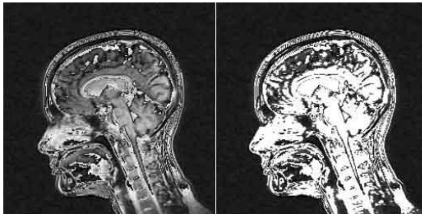
Figura 39. Izquierda: Imagen DICOM original. Derecha: Resultado de aplicar el filtro Umbral General en Modo Arriba ( Mode Above ).
