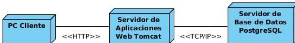
**Figura 19:** Diagrama de despliegue.
