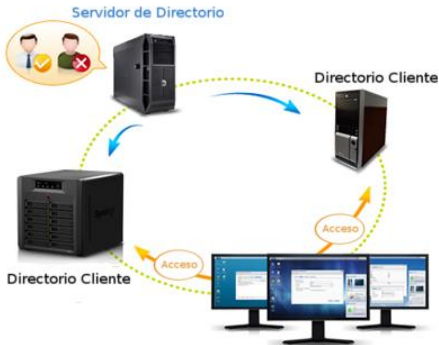
Figura 1 Funcionamiento de LDAP
