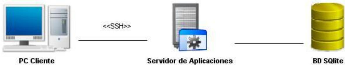
Figura 14. Diagrama de despliegue
